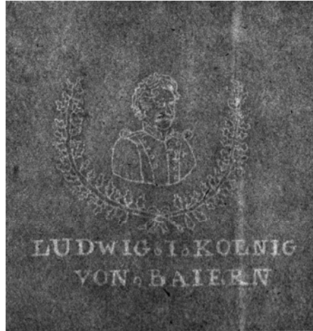
Abb. 5: Wasserzeichen aus einem Velinpapier der Papiermühle Mindelheim. Der Schriftzug »LUDWIG I. KOENIG VON BAIERN« wurde um 1835 von dem Papiermacher Joseph Hundegger als Vollwasserzeichen ausgeführt (Dietz/Schmidt 2009: 21).
