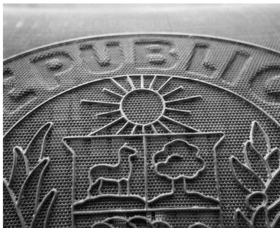
Abb. 7: Abbildung eines Egoutteurs aus dem Jahr 1923 für ein Hell-Dunkel-Wasserzeichen mit dem Schriftzug »REPUBLICANA PERUANA« 13 (Dietz/Schmidt 2009: 26).
